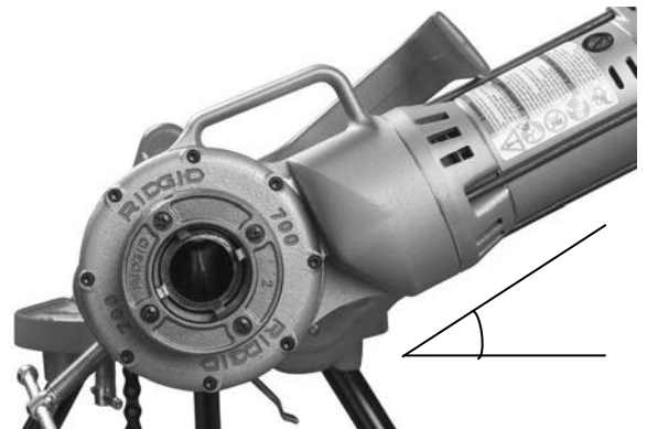
Abbildung 6 – Stützarm positioniert, Kraftantrieb 700 leicht über der Horizontalen
