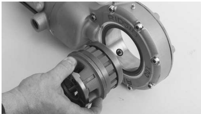
Figura 4 – Montarea capetelor filieră în clupa electrică 700
