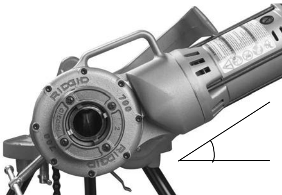
Obrázek 6 – Podpěrné rameno umístěné vodorovně lehce pod elektrickou závitnicí 700
