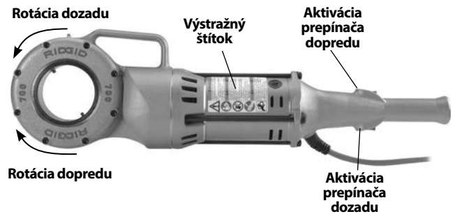
Obrázok 3 – Poloha prepínača pre smer otáčania
