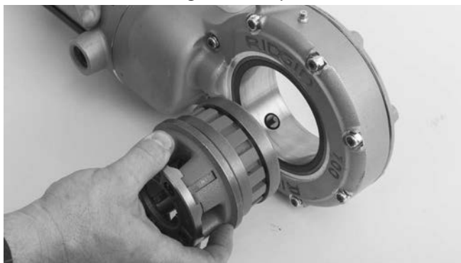
Figuur 4 – Draadsnijkoppen aanbrengen in de Power Drive 700
