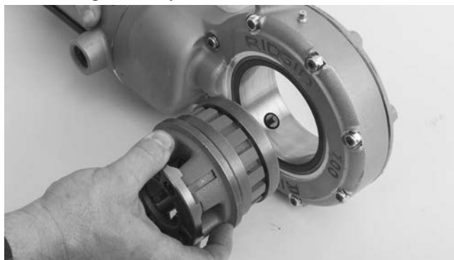
Figur 4 – Montering af skærehoveder i det elektriske rørdrev 700
