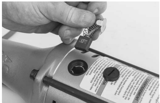
Figura 13 – Instalação da Escova
