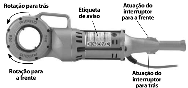
Figura 3 – Posição do interruptor para direção rotacional
