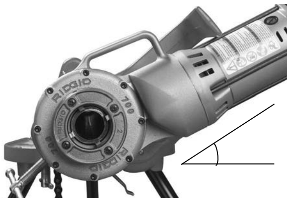
6. ábra – A kitámasztó kar elhelyezkedése a kissé a vízszintes sík felett levő 700-as hajtóegységgel
