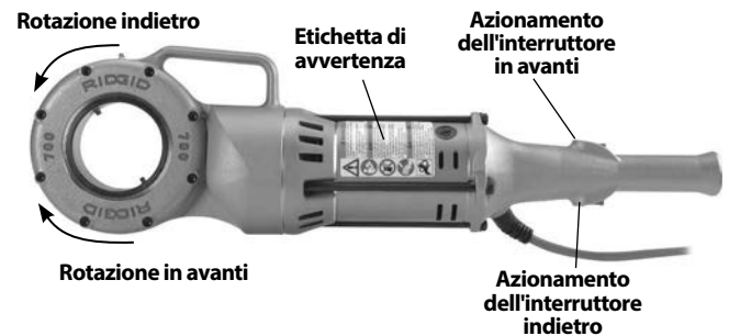
Figura 3 – Posizione dell'interruttore per la Direzione di rotazione
