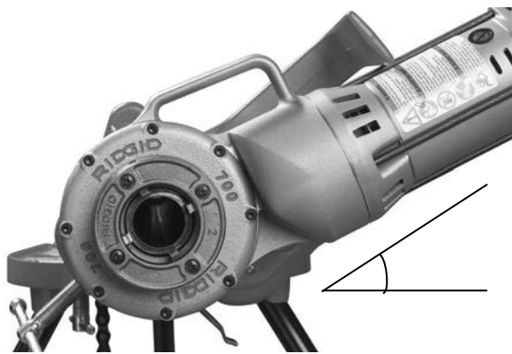
Рис. 6 – Струбцина-фиксатор с силовым приводом 700, который расположен немного выше горизонтали
