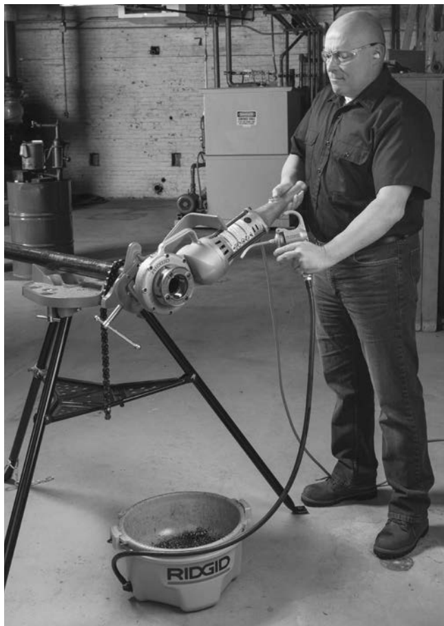
Figur 9 – Gevindskæring af rør
