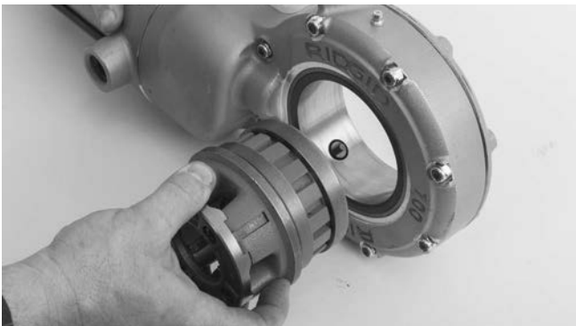
Kuva 4 – Kierrepäiden asennus 700-käyttölaitteeseen
