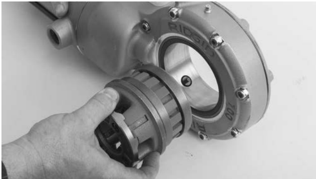
Εικόνα 4 – Τοποθέτηση φιλιέρων στον ηλεκτρικό βιδολόγο 700
