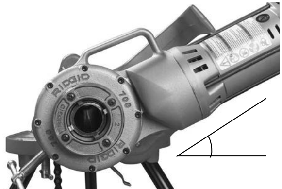
Kuva 6 – Tukivarsi sijoitettuna ja 700-käyttölaite hieman vaakatason yläpuolella
